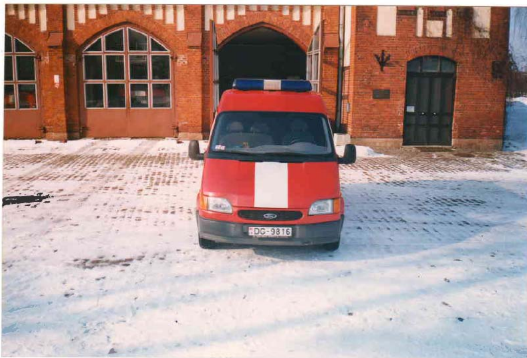
Ātrās reaģēšanas brigādes Speciālās tehnikas daļas, Hanzas iela 5, speciālais automobilis uz FORD Transit bāzes ar augstspiediena dzēšanas iekārtu Minimax, 90-to gadu beigās, 2000. gada sākums.
