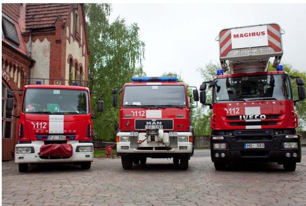
Ugunsdzēsēju depo, Rīgas reģiona pārvaldes 9. daļa, Hanzas ielā 5, 2012. gads, autocisterna AC uz IVECO Eurocargo bāzes, 2002. gada izlaidums, glābšanas automobilis GA uz MAN bāzes ar vinču un manipulatoru aizmugurē (3,5 t celbspēja) un autokāpnes AK-37 uz IVECO Stralis bāzes, 2008. gada izlaidums.
