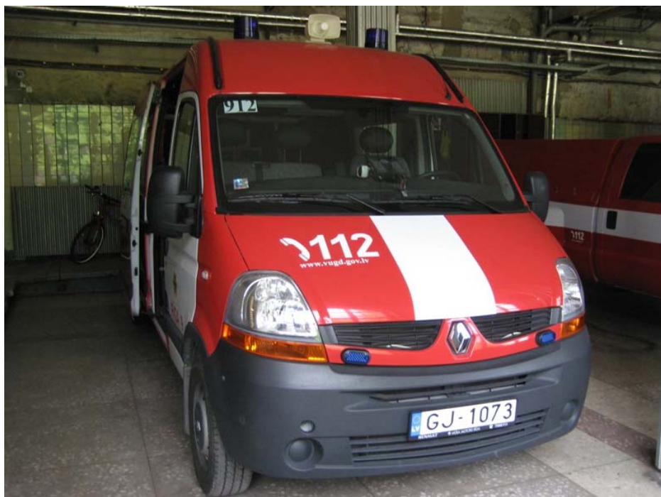
Ugunsdzēsēju depo, Rīgas reģiona pārvaldes 9. daļa, Hanzas ielā 5 (garāžā), tehniskais automobilis TA uz Renault Master 2006. gada izlaiduma bāzes ar augstspiediena dzēšanas sistēmu COBRA, 2012. gads.
