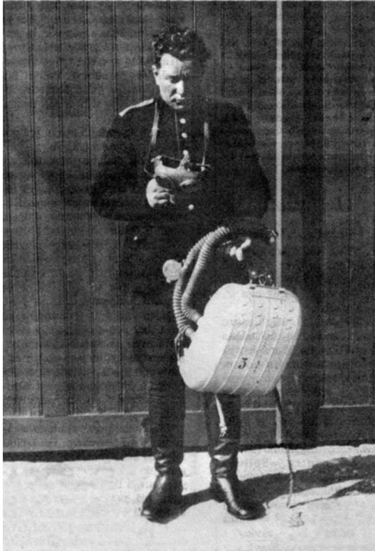
E.Kauliņš Rīgas I V ugunsdzēsēju nodaļā pārbauda skābekļa elpošanas aparātu „Dregea”.
