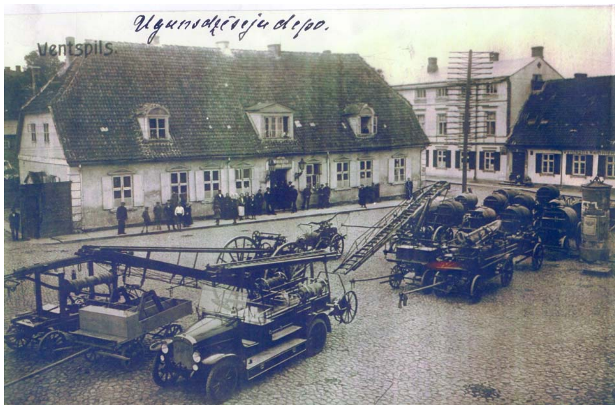
Ventspils BUB tehnika pilsētas Rātslaukumā, 1928.gadā. Centrā automobilis „Magirus”(Vācija) un trīspakāpju izbīdamās balansa kāpnes „Justus Christian Braun A.G.”(Vācija).
