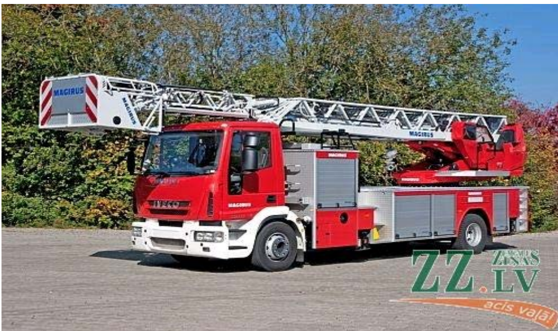
Jaunās autokāpnes kāpnes IVECO MAGIRUS ML160E30, Jelgavas daļai 42 m (Foto no portāla Zemgales ziņas)
