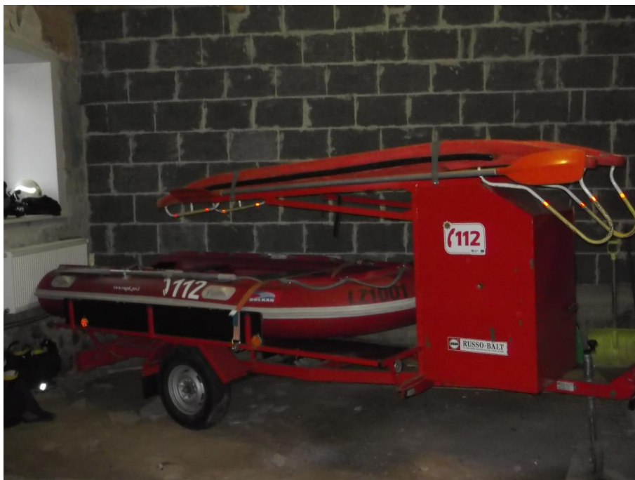
Piekabe ar gumijas laivu un dzinēju, virs laivas ``Hanzas`` tipa glābšanas dēlis, tiek izmantots lai veiktu glāšanas darbus gan uz ūdens, gan ledus. Piekabe ar aprīkojumu tiek pārvietota izmantojot automobīli MB ``Unimog -1300 L``-
