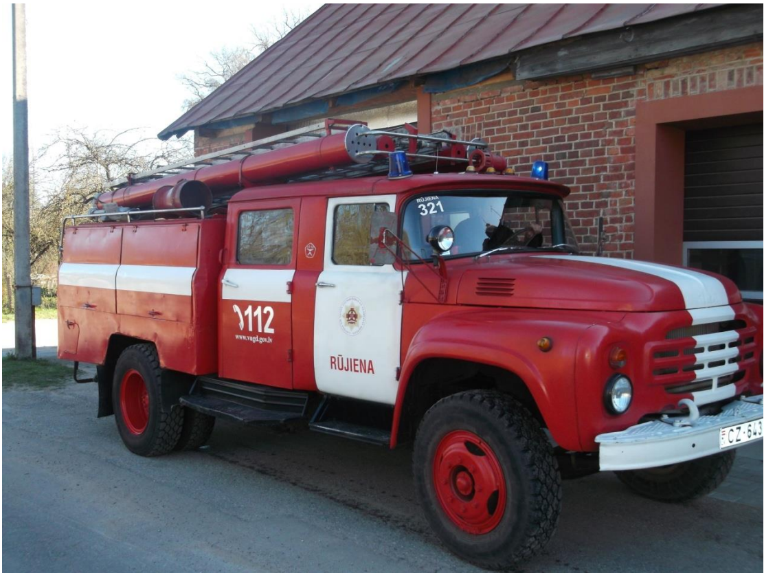
Ugunsdzēsības automobīlis ZIL-130 (AC-40), 1988.gada izlaidums, ūdens tīlpums cisternā 2450 litri, aizmugurējā tilta piedziņa, apbruņojumā no 2001.gada. Degviela, A -95 markas benzīns, degvielas patēriņš 40 litri uz 100 km.
