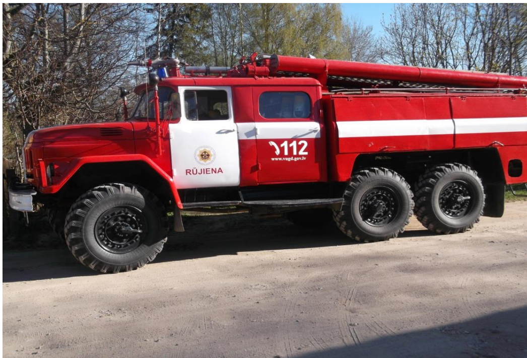
Ugunsdzēsības automobīlis ZIL-131 (AC-40) , 1973.gada izlaidums, ūdens tilpums cisternā 2400 litri, trīs velkošo tiltu piedziņa, apbruņojumā no 2001.gada. Degviela, A -95 markas benzīns, degvielas patēriņš 49 litri uz 100 km. E.Bambāna foto
